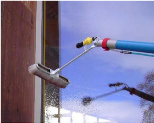
Poutrelle de tête avec buse spéciale pour pulvérisation économique (consommation minimale du produit Adesectin).
